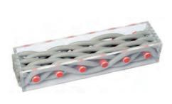
Die Webart der Köpertressen ergibt für Monofilamente die kleinsten Filterporen und eine glatte Gewebeoberfläche, der grosse Materialquerschnitt sorgt für eine hohe Gewebefestigkeit. Beim Durchströmen der Köpertressen überwinden die Partikel fünf versetzte Porenebenen. Dadurch werden auch
