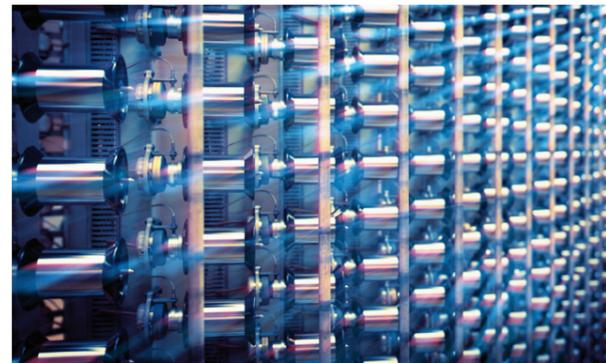
Zetteltatter mit über 1000 Kettendraht-Spulen
